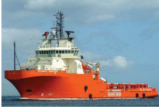
Un remorqueur de manœuvres de mouillage fabriqué par Irving Shipbuilding
