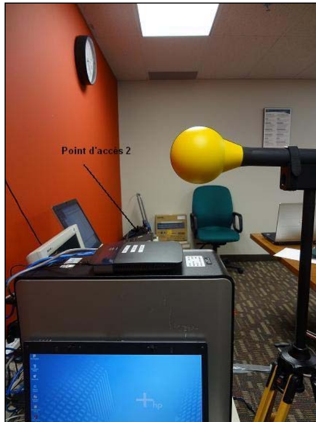
Figure 2 – Montage du PA2 (2 437 MHz) à 1,1 mètre du plancher
