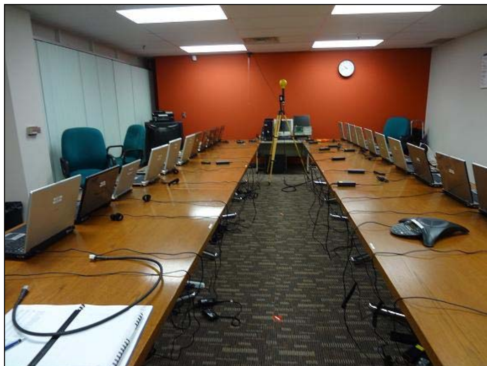
Figure 5 – Montage pour la mesure des champs Wi-Fi dans la salle de conférence
